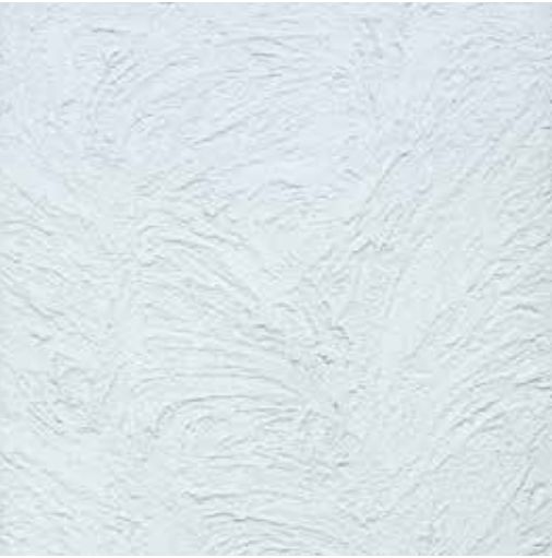
うず 木ゴテを回しながら模様を付け、金ゴテで押さえた仕上げ。 仕上厚：3mm
