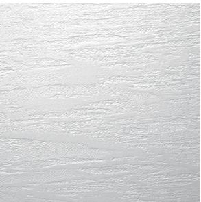
フレスコ 木ゴテで横引き模様を付け金ゴテで押さえた仕上げ。
