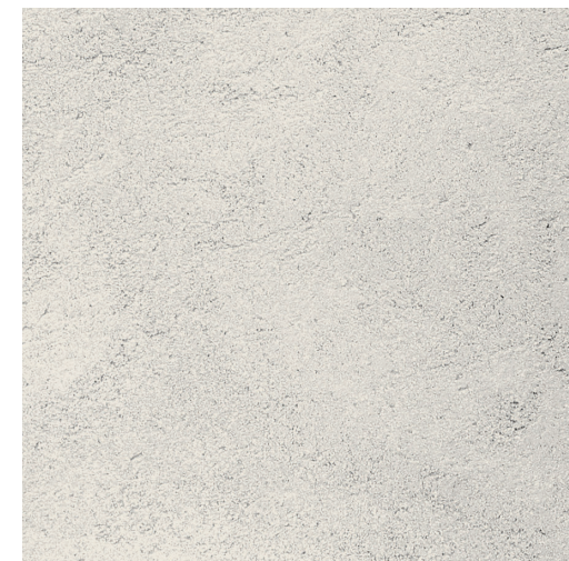
砂岩 表面をランダムに金ゴテで押さえた平滑な仕上げ。 仕上厚:3mm
