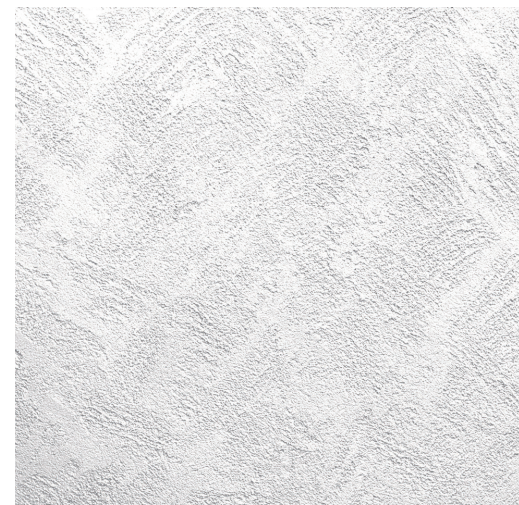
ノワ 木ゴテでクロス柄を引き、金ゴテで表面を押さえた仕上げ。 仕上厚:3mm
